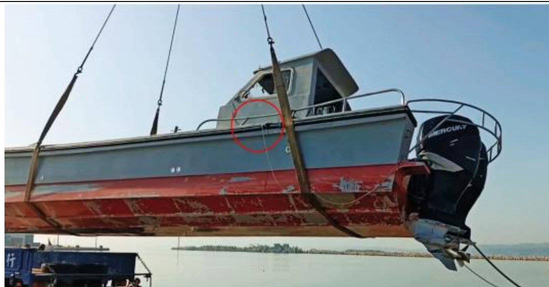
照片一：陸籍快艇雖有碰撞痕跡，但未見船體有嚴重變形或大面積之損壞。
